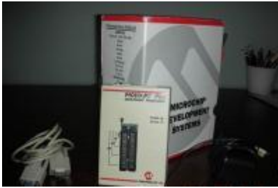
Fig. 15. Quemador PICSTART Plus desarrollado por Microchip. [8]
