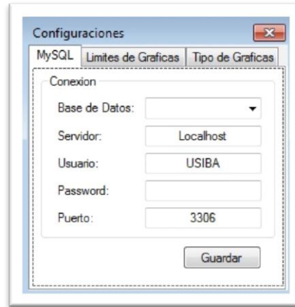
Fig. 7. Pestaña MySQL, configuraciones de la conexión a la base de datos de USIBA.
