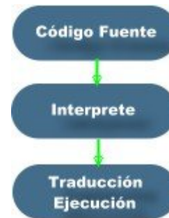
Figura 2. Funcionamiento de un intérprete
