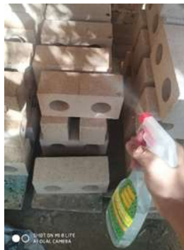
Figura 4. Bloques en proceso de curado luego de ser prensados en el equipo Cinva-Ram.
