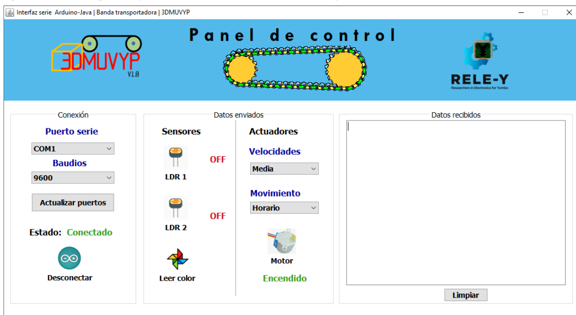
Figura 4. Interfaz gráfica para interacción con la banda transportadora
