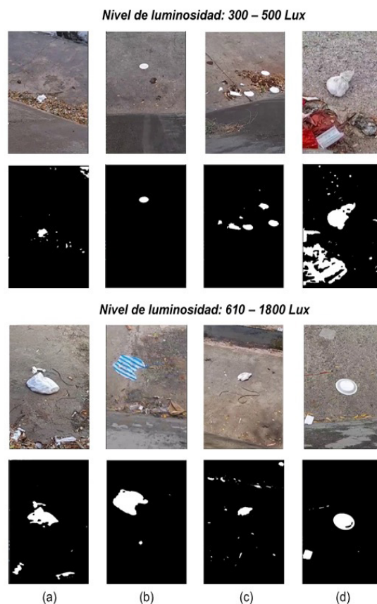
Figura 2. Detección de residuos mediante segmentación por color. (a) altura de 1.5 m y ángulo de inclinación de 60°. (b) altura de 1.5 m y ángulo de inclinación de 20°. (c) altura de 0.5 m y ángulo de inclinación de 60°. (d) altura de 0.5 m y ángulo de inclinación de 20°.
