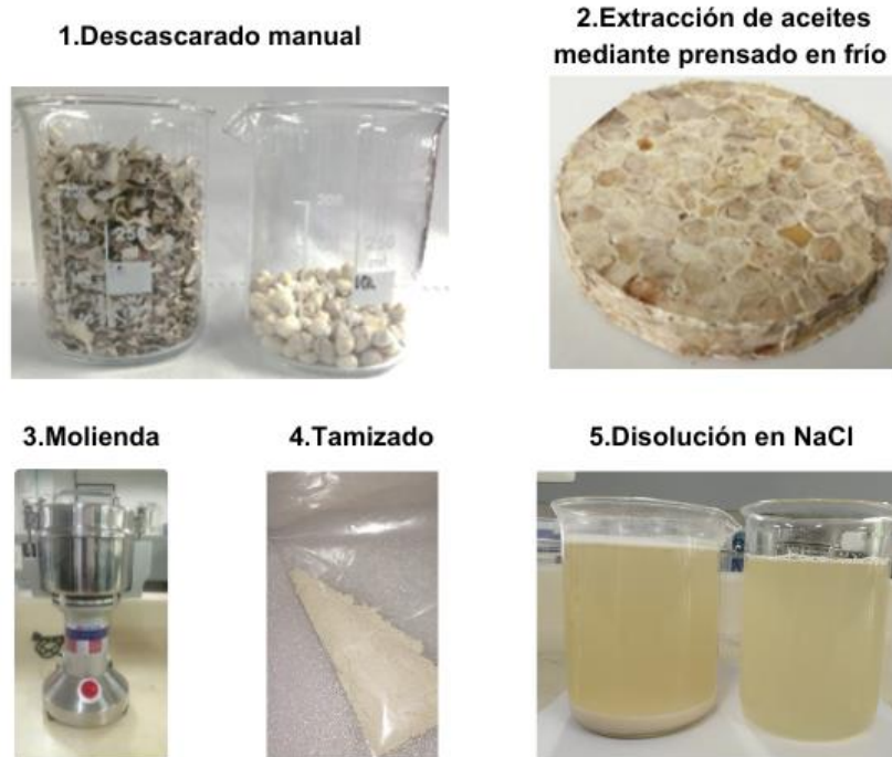
Figura 1. Proceso de preparación del biocoagulante basado en semillas de Moringa oleífera.
