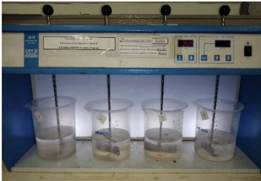
Figura 2. Equipo de prueba de jarras.
